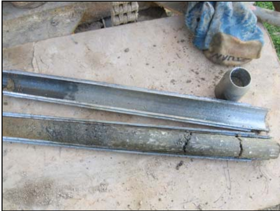
Foto 13: Sondeig S-4. SPT a 1,5 metres.
