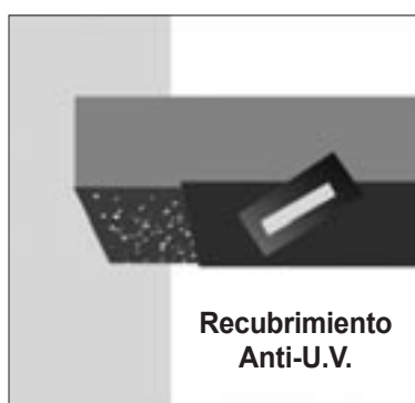
7. Aplicación de un recubrimiento protector Anti-U.V.
