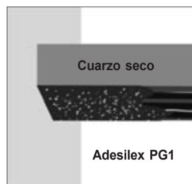
6. Aplicación de ADESILEX PG1. Posterior aplicación de cuarzo seco.
